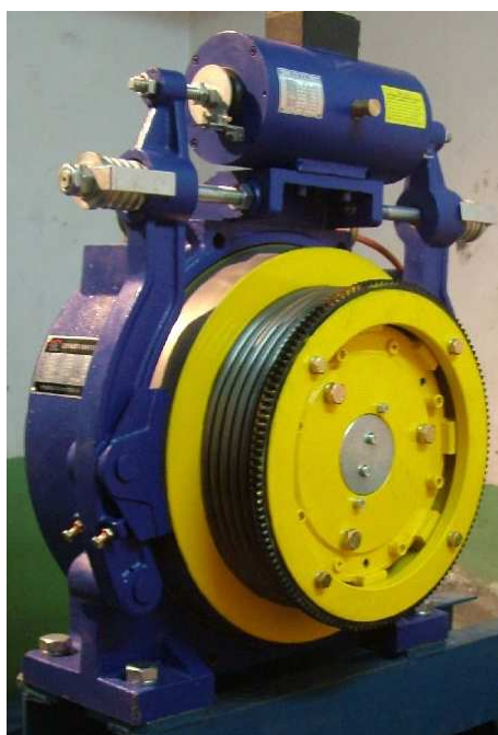
Рис. 2. Привод лифта (лебедка).
