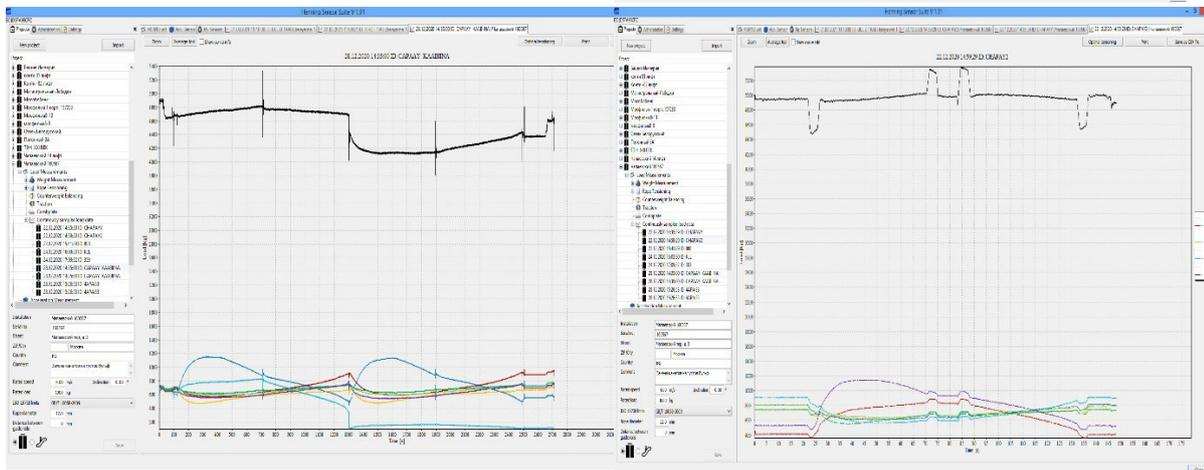
Мировые производители стальных канатов рекомендуют использовать данный прибор при монтаже стальных канатов и в дальнейшем контролировать их в период эксплуатации. Равномерное натяжение канатов позволяет сохранить оборудование лифта в исправном состоянии на весь срок службы, такие узлы как КВШ (канатоведущий шкив), отводные блоки, подвеска, пружины будут работать в исправном состоянии и изнашиваться равномерно в соответствии с его назначенным сроком службы.
