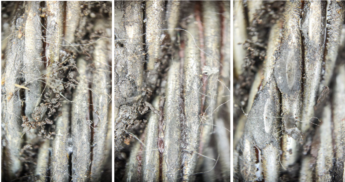
Фото тяговых канатов до проведения смазки при увеличении 200x
