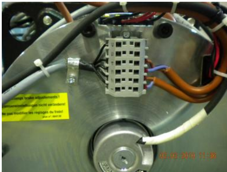
Рисунок 2. Схема подключения тормоза после модификации
