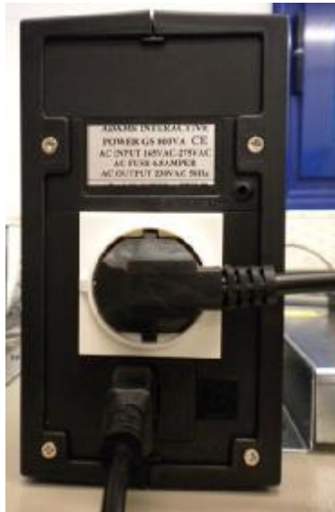
Рисунок 4.16: Схема соединения блока бесперебойного питания
