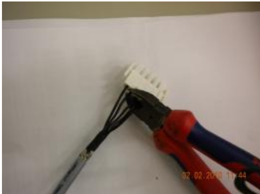
Рисунок 4. Удаление разъема кабеля тормоза
