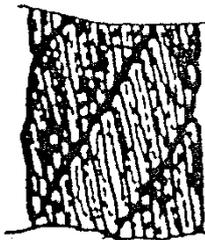
Рис. 6. Поверхностная коррозия проволок каната:
