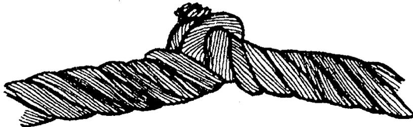
Рис. 16. Перекручивание каната
