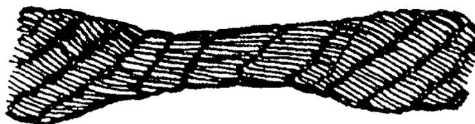
Рис. 13. Сплющивание каната
