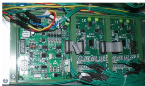
[SM-02-G/SM-03-D внутри поста управления COP]
