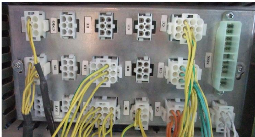
[MIC разъемы на монтажной плате]
