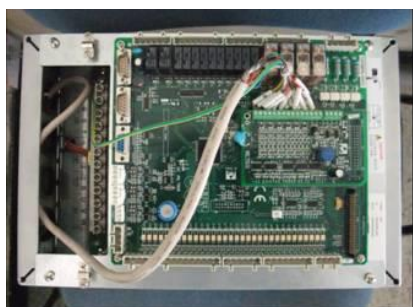
[Главная плата + задающее устройство в сборе]
