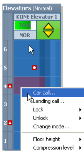
Рис. 11: Выбор кабинного приказа – пункт меню в контекстном меню или двойной клик на шахте лифта.
